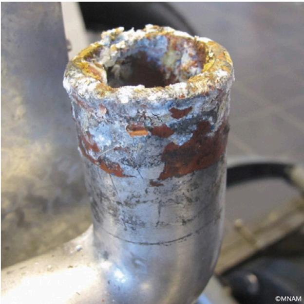
**Fig. 4:** Corrosion sous la durite d'une pipe de Bugatti. Démontage pour restauration. ©MNAM
