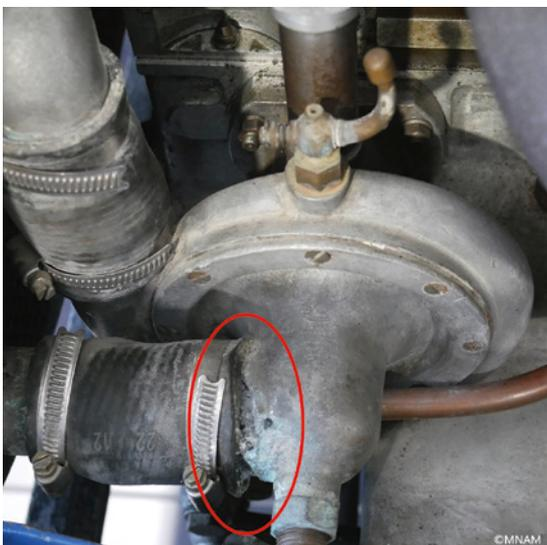
**Fig. 3:** Corrosion sous la durite à l'entrée d'une pompe à eau de Bugatti. ©MNAM
