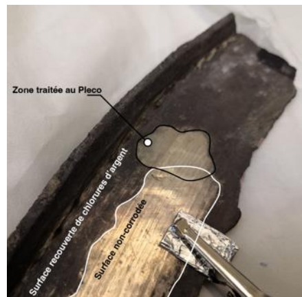
Détail du fragment n°3 après réduction de chlorures d'argent avec le Pleco®, ©Romain Jeanneret
