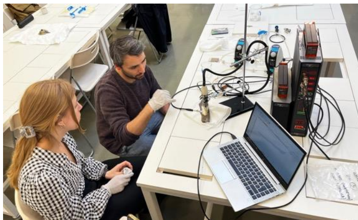
Installation pour les analyses des produits de corrosion et leur réduction avec le Pleco® et un potentiostat. ©Eva Menart
